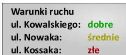
Rys. VI.5 Znak zmiennej treści z informacją tekstową o panujących warunkach ruchu
