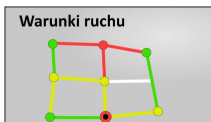
Rys. VI.6 Znak zmiennej treści z informacją graficzną o panujących warunkach ruchu
